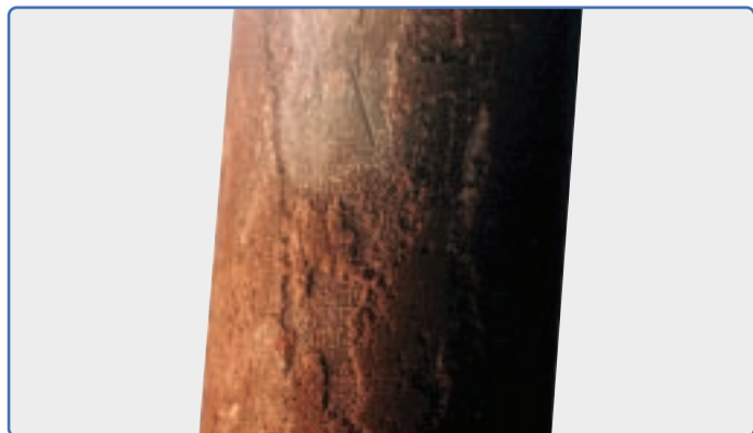
Tubo de polipropileno monocapa. Fotodegradado por exposición a rayos U.V.
